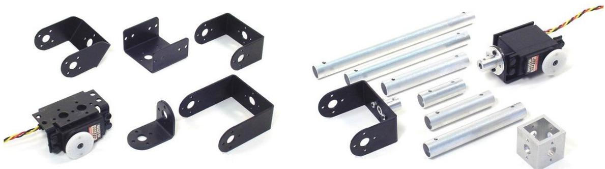
Figura 2. I pezzi utilizzabili per la costruzione di vari robot, ed in parte usati per la costruzione del braccio robotico: servomotori, staffe ad U, sostegni dei servomotori, tubi di struttura di varia misura, basi per il fissaggio dei tubi alle staffe. Tutti i pezzi, con l'eccezione dei servomotori, sono in lega di alluminio, molto leggeri, resistenti e facilmente assemblabili e modificabili con un'attrezzatura molto semplice.
